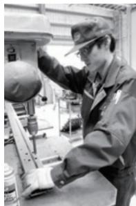
ロボットシステムの機械を製作中。組み立てのための穴を開けていく。
