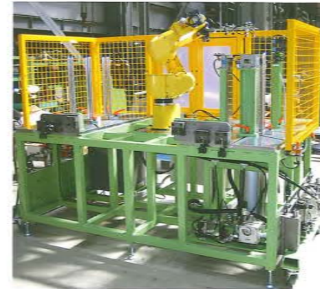
プレス用ローディング・アンローディングロボット Loading and Unloading robot system to press machines
