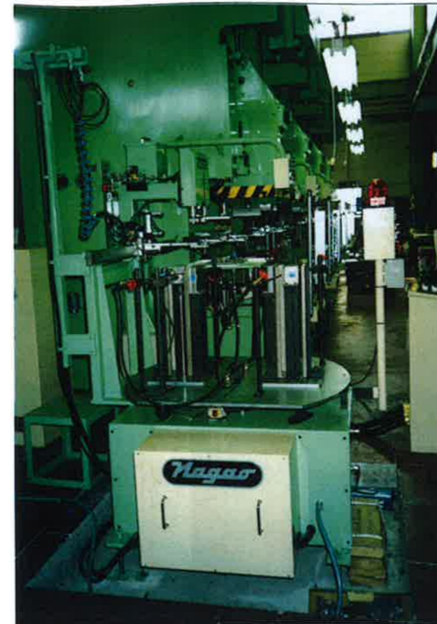
2スタック回転式ブランクリフター ワーク寸法：400mm角
