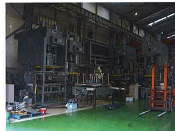
NCP-250(1台)+NCP-200(3台)+ERロボット +多軸ロボット(2台)
